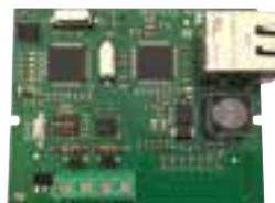
**4437106 XFIRE-WEB** Scheda per connessione TCP-IP per centrali XFIRE
