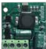
**4437125** | **RDT** | Riduttore di tensione 24Vdc a 12Vdc
