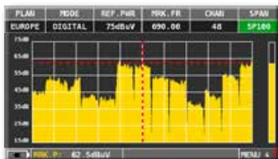
Spettro TV span 100 MHz
